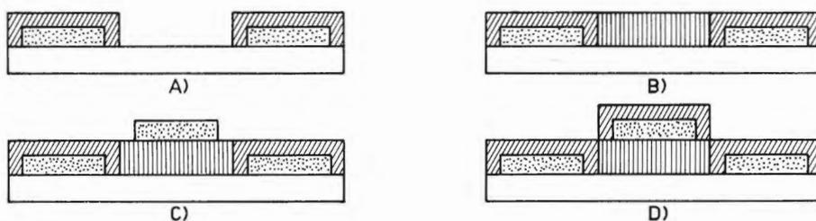
Fig. 113 - Aggiunta di tracce nuove su C.S. additivo.
