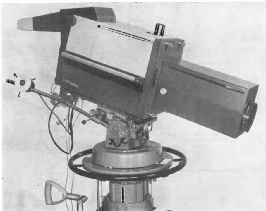
Fig. 4 - La telecamera Marconi Mark-VII, che impiega i tubi vidicon con strato di ossido di piombo.
