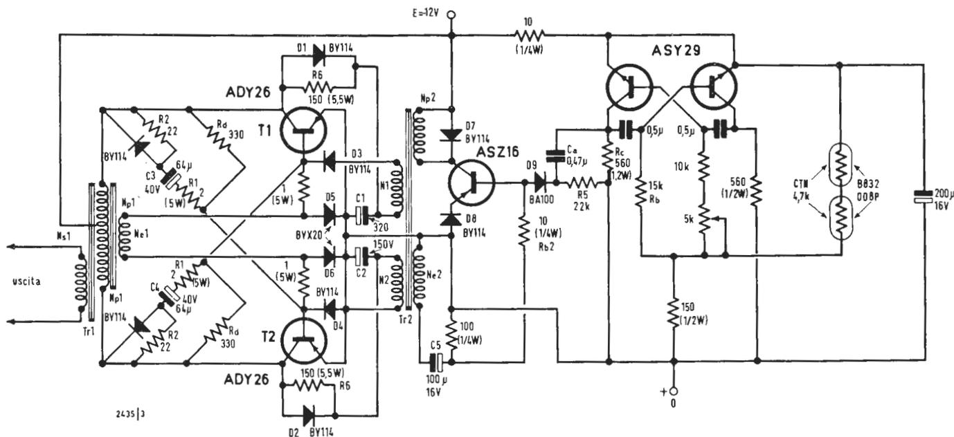
Fig. 1 - Schema elettrico del convertitore 250 W, 50 Hz.
