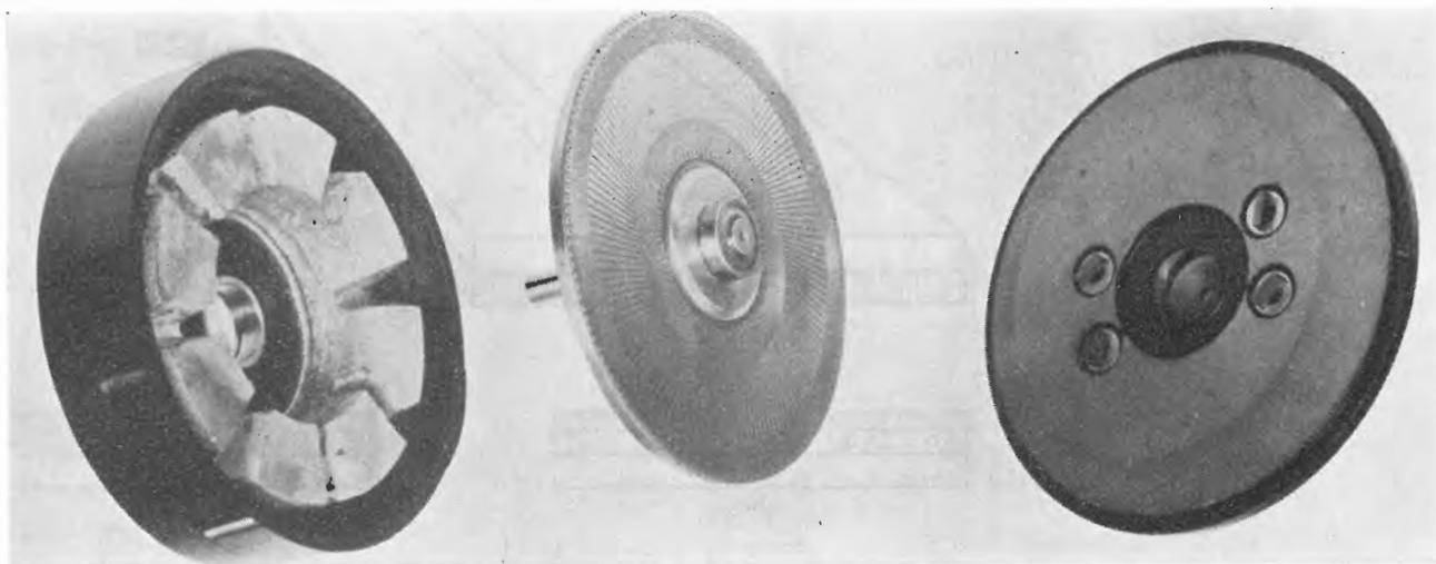
Fig. 115 - Parti di motore a rotore stampato.
