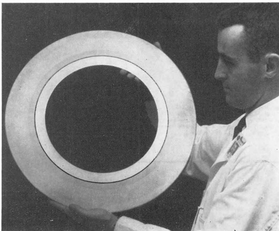
Fig. 117 - Rotore stampato a grande rapporto spessore/diametro.
