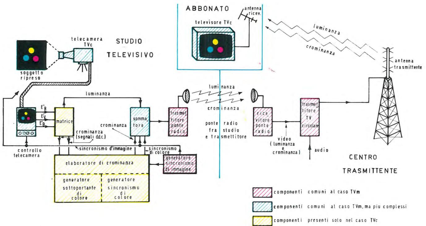
Fig. 27 - Schema a blocchi della catena TVc con particolare riguardo al lato trasmissione, valido per tutti i moderni sistemi di televisione a colori.
