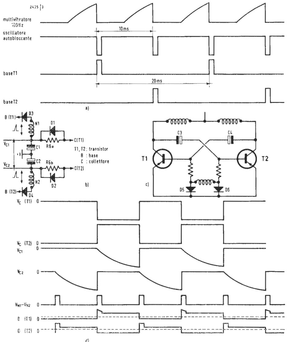
Fig. 2 - Segnali forniti dal multivibratore, poi dall'oscillatore bloccato e applicati alle basi dei transistori di potenza (a). Principio dell'eccitazione (b) destinato a far commutare i transistori di potenza (c). Segnali ottenuti in diversi punti del circuito (d). In realtà  $B(T_2)$  è identico a  $B(T_1)$ , solo i guizzi sono leggermente diversi.
