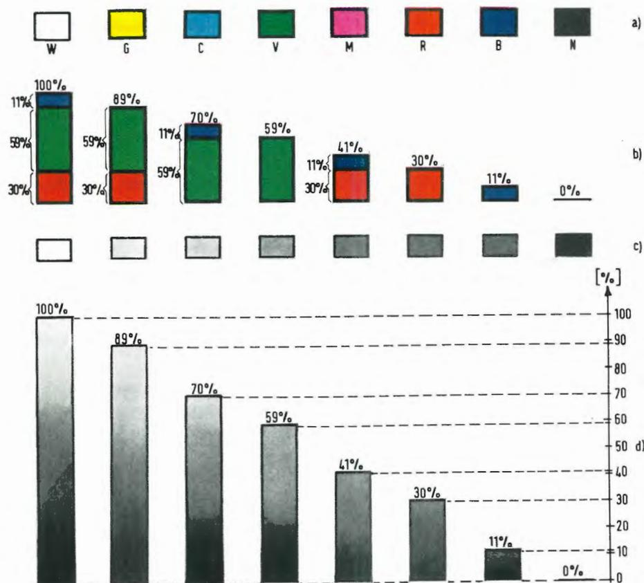
Fig. 24 - a) Principali colori che si incontrano nello studio della TV; b) loro composizione; c) luminanze massime corrispondenti; d) dinamica delle luminanze per ciascuno dei colori considerati.
