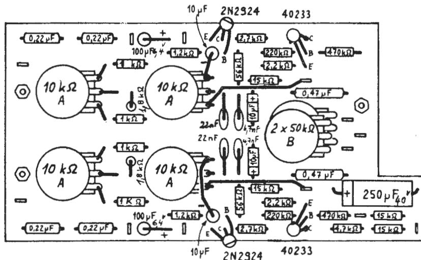
Fig. 5 - Disposizione dei componenti sul te a io dei correttori.
